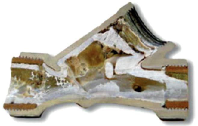
In wasserführenden Leitungen setzt sich der Kalk mit der Zeit, je nach Härtegrad des Wassers in den Rohren ab und bildet kristalline Strukturen (Argoniten), die letztendlich zu Druckverlust und später zur Verstopfung der Wasserrohre und somit auch zum Wasserrohrbruch führen können. Erheblichen Sanierungskosten sind die Folge.
