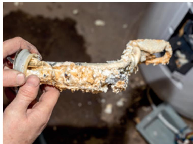
Abb.: verkalkter Heizstab aus einem Boiler
