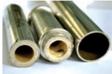
Querschnitt Wasserrohre vor und mehrere Monate nach Inbetriebnahme des AqualInduct-profi-® 800.
